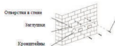
При навешивании наклонной вытяжки, перед установкой необходимо просверлить дополнительно 4 отверстия диаметром 8 мм.
