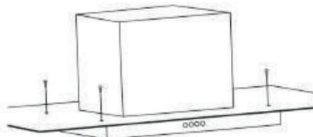
Если стеклянный купол вытяжки не был собран на фабрике, закрепите его к верхней части корпуса вытяжки.
