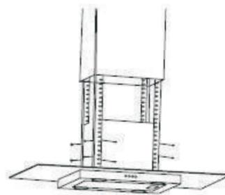
**ВАЖНО:** Установка островной вытяжки должна проводиться вдвоем. Надежно закрепите 16 болтов М5.
