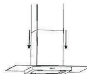
Если вытяжка будет использоваться в режиме отвода, прикрепите выводную трубу к потолку.
