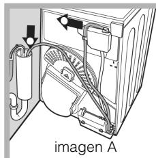
Extraiga la manguera existente de la posición que se muestra en la imagen A.
