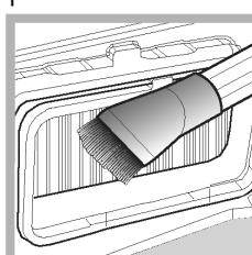
4. Rimuovere accuratamente la lanugine con un panno umido, una spugna o un aspirapolvere.
