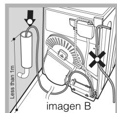
A continuación instale una manguera con una longitud adecuada en la posición que se muestra en la imagen B.
