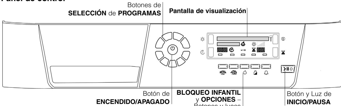
Si se pulsa el botón ENCENDIDO/APAGADO cuando la secadora está en funcionamiento: Si la pantalla indica [DESCONEXIÓN], la secadora se para. Si la pantalla indica [PULSAR Y MANTENER], pulse el botón y en la pantalla se observará una cuenta atrás 3, 2, 1 y la secadora se parará.
