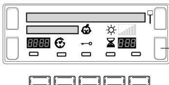
Après avoir sélectionné un programme comportant une option Séchage minuté, appuyez sur le bouton de durée de séchage, le temps sélectionné augmente sur l'affichage chaque fois que vous appuyez brièvement sur le bouton (*voir Démarrage et Programmes*).
