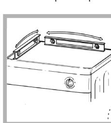
Después de haber instalado la secadora en su ubicación definitiva, compruebe que está nivelada en sus laterales y de delante a atrás. Si la secadora no está nivelada, ajuste las dos patas delanteras hacia arriba o hacia abajo hasta conseguir que su secadora quede nivelada.
