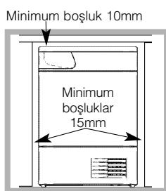
Bu gereken hava devridaimini sağlar. Cihaz arka yüzeyi duvara bakacak şekilde monte edilmelidir.
