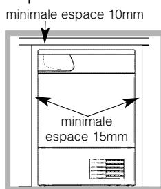
espace de 15 mm entre les côtés et les éléments d'ameublement ou les murs latéraux. Ceci a pour objectif d'assurer une ventilation convenable.
