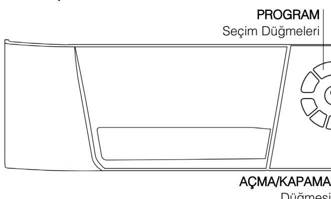
AÇMA/KAPAMA düğmesi - kurutucu çalışırken basıldıysa: Gösterge **KAPATMA** gösteriyorsa kurutucu durur. Gösterge **BASILI TUTUN** gösteriyorsa düğmeye basılı tutun ve gösterge 3, 2, 1 şeklinde geriye sayar ve sonra durur. 3 saniyeden fazla tekrar basılı tuttuğunuzda, gösterge kısaca **AÇMA** gösterir.
