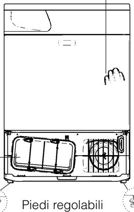
Unità del filtro della pompa di calore (coperchio aperto)
