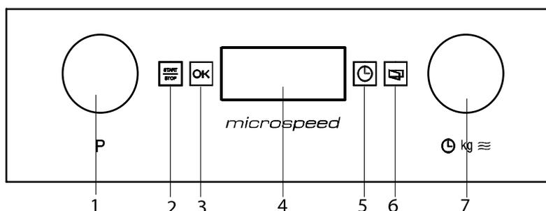
1. Drehen Sie den Funktionswahlschalter (1), bis die Grill Funktionsanzeige zu blinken beginnt. Auf dem Uhr/Dauer Display blinkt nun „10:00“.
