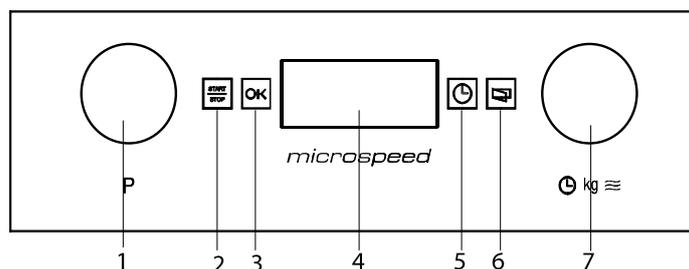
1. Drehen Sie den Funktionswahlschalter (1), bis die Anzeige des Mikrowellenbetriebs zu blinken beginnt. Auf dem Uhr/Dauer Display blinkt nun „1:00“.
