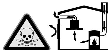
Ohniská závislé od vetrania miestnosti (napr. vyhrievacie prístroje na plyn, olej, drevo alebo uhlie, prietokové ohrievače, ohrievače vody) odoberajú dymové plyny z miestnosti, kde sú nainštalované a odvádzajú ich odsávacím zariadením (napr. komín) von.
