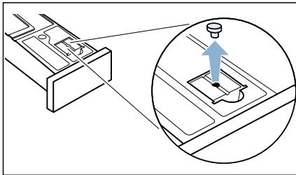
3. Поверните резервуар для конденсата на 180° на нижнюю сторону и удалите вставленную пробку.
