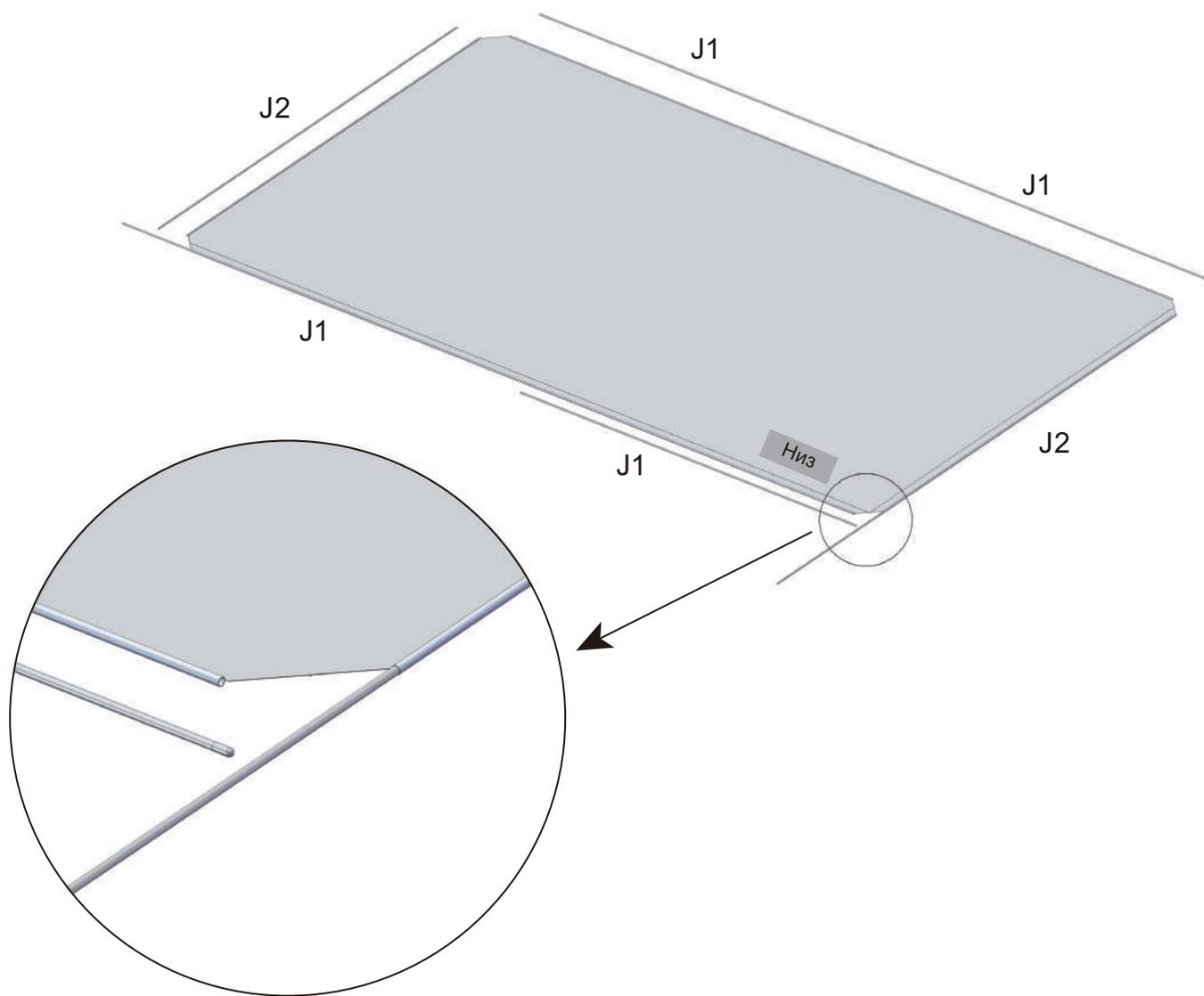
3. Вставьте края экрана в канавки натяжного стержня (N) и натяжного стержня (M), как показано на рисунке ниже.
