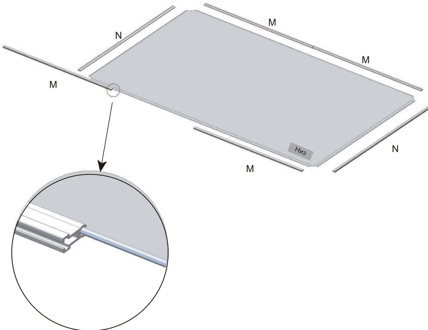
4. Выровняйте внутреннюю раму по центру на задней стороне экранного полотна.
