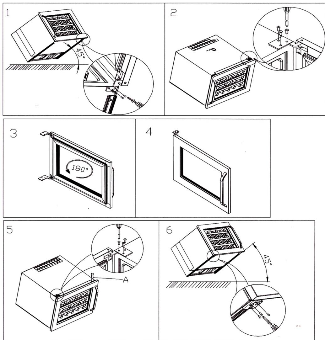
1. Наклоните шкаф на  $45^\circ$  и выкрутите болты на нижней петле (рис.1)
