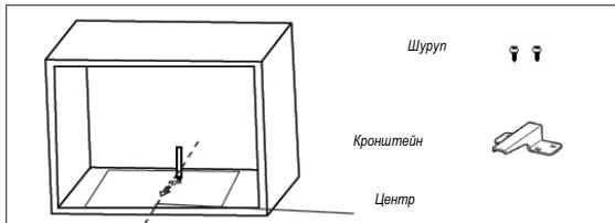
3. Поднимите шаблон нижнего остова и закрепите шурупом А.
