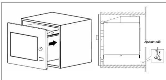
5. Откройте шкаф и зафиксируйте пекь шурупом «В» в отверстие установки, после чего закройте отверстие пластиковой заглушкой.
