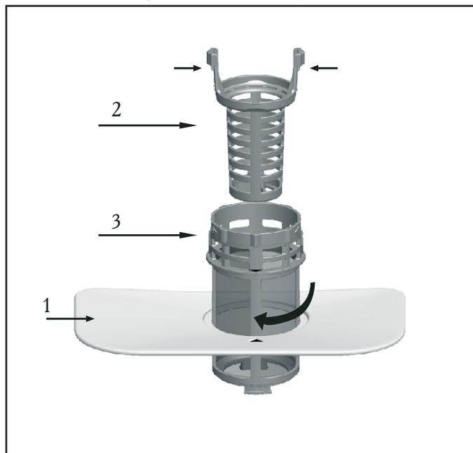
Система фильтров состоит из плоского стального фильтра, а также из фильтров грубой и тонкой очистки.
