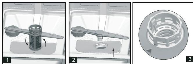
**Очистка фильтров производится следующим образом:**
