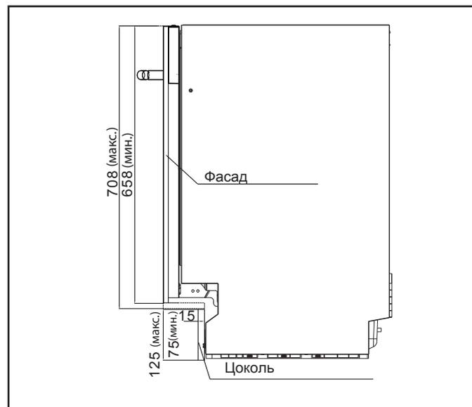
Для правильного расчета высоты цоколя при установке с учетом эстетичности внешнего вида и плавного открывания/закрывания двери, вы можете воспользоваться данными таблицы.
