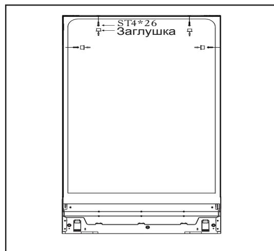
1. Закрепите посудомоечную машину в нише шкафа с помощью 4-х саморезов ST4x26, как показано на рисунке.
