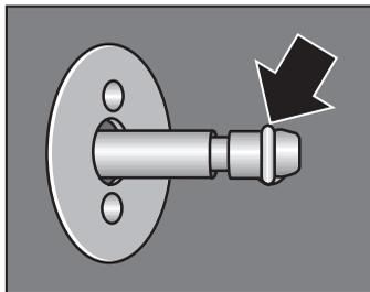
С внутренней стороны дверцы прибора находится деталь, соединяющая устройство заваривания и выпускную насадку для кофе.
