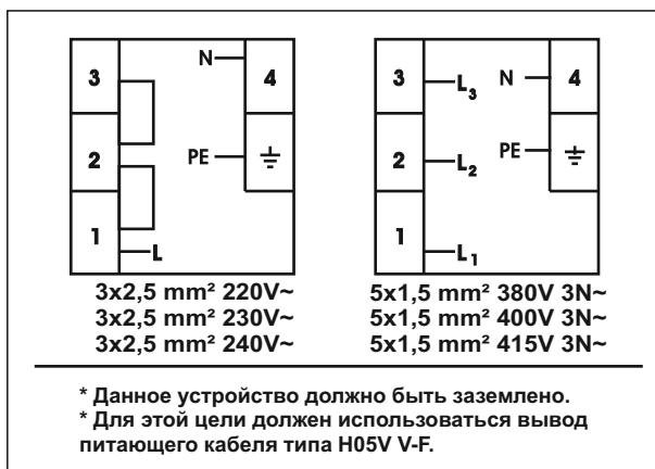
При использовании индукционной конфорки необходим кабель следующего типа: H05VV-F 3X2,5 мм<sup>2</sup>/60227 I EC 53 . Схема соединений расположена на дне устройства..
