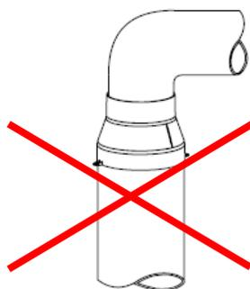
**D.** Il est recommandé d'utiliser des conduits qui ont une perte de charge minimale par frottement, plus les parois sont lisses meilleur est le résultat et si les conduits sont flexibles, placez-les bien tendus pour que les parois spiralées soient aussi lisses que possible, car cela améliore le niveau d'aspiration et réduit le niveau sonore.
