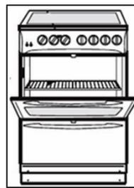
Réactiver le filtre à charbon FCLR AE, une fois lavé et séché, en le plaçant dans un four à une température ne dépassant jamais 90 °C pendant environ 60 min.
