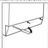
2. проверьте, чтобы уровень воды в машине был ниже отверстия люка. В противном случае слейте излишек воды через сливную трубу в ведро, как показано на *схеме*. 3. снимите переднюю панель стиральной машины при помощи отвертки (см. схему)
