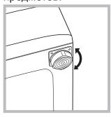
2. После установки машины на место отрегулируйте ее устойчивое положение путем вращения передних ножек (см. рис.). Для этого сначала ослабьте контргайку, после завершения
