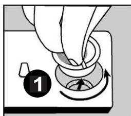
Для заливки ополаскивателя, открутите крышку отсека (1). Заливайте ополаскиватель, пока индикатор не потемнеет (2). Закрутите крышку обратно. В будущем вы сможете проверять наличие ополаскивателя в отсеке при помощи индикатора. Темный цвет индикатора означает, что ополаскиватель присутствует. Светлый цвет означает, что пора добавить ополаскиватель в отсек.
