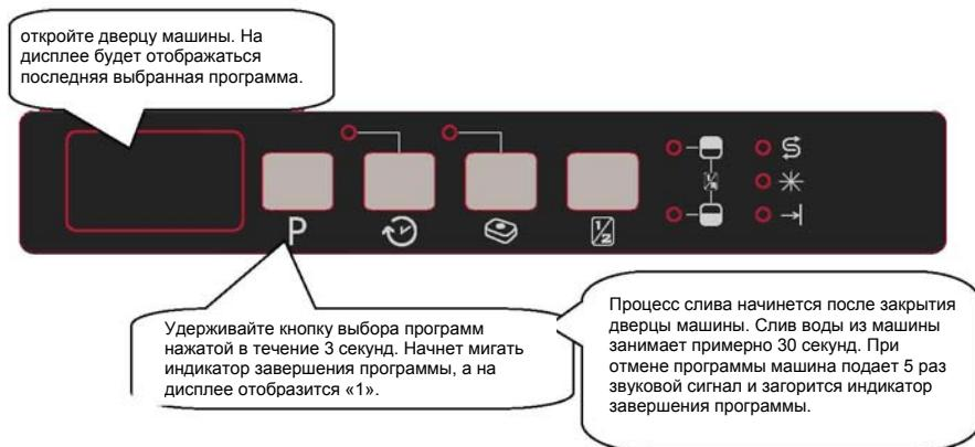
**Примечание.** При открывании дверцы машины для остановки выполнения программы мойки до ее завершения сначала лишь приоткройте ее, чтобы избежать выплескивания воды.
