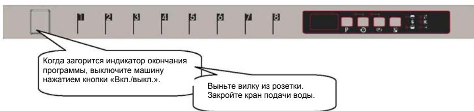
**Примечание.** После звукового сигнала, указывающего на завершение выполнения программы, когда выполнение программы мойки подойдет к концу (горит индикатор завершения выполнения), вы можете оставить дверцу машины слегка приоткрытой, чтобы ускорить процесс сушки.
