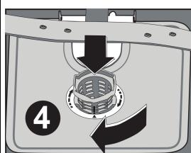
Чтобы извлечь фильтр для очистки, выкрутите его против часовой стрелки и извлеките вверх.
