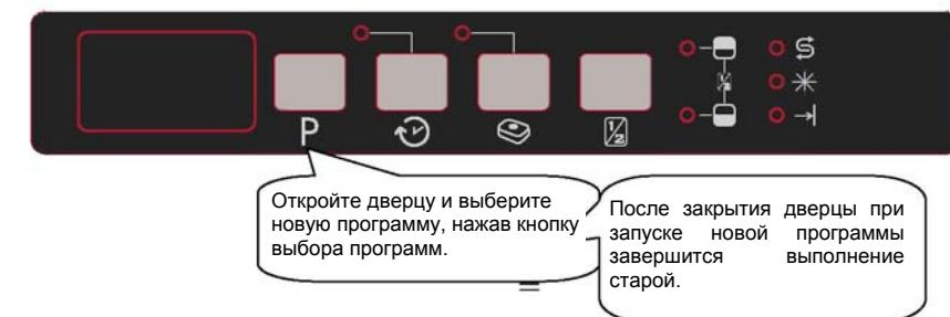
**Примечание.** При открывании дверцы машины для остановки выполнения программы мойки до ее завершения сначала лишь приоткройте ее, чтобы избежать выплескивания воды.
