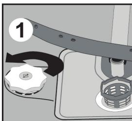
Используйте умягчающие соли, которые специально произведены для использования в посудомоечных машинах. Для добавления соли, отвинтите крышку против часовой стрелки. Засыпьте 1 кг., соли и долейте воду до уровня. После этого установите на место крышку, закрутив по часовой стрелке.
