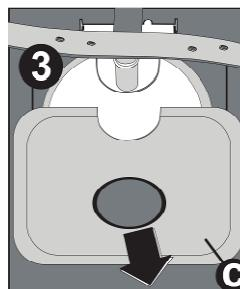
Отсоедините фильтр (а), затем извлеките из микрофильтра, фильтр грубой очистки. Промойте его под большим количеством теплой воды из-под крана. Соберите фильтр в обратной последовательности.
