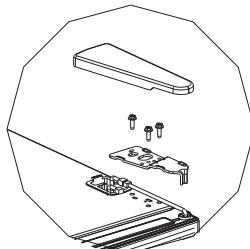
3. Снимите среднюю петлю, винты, заглушки для винтов и снимите дверцу морозильной камеры.
