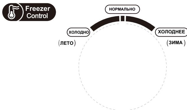
Температура замерзания относительно низкая в положении "ХОЛОДНЕЕ", в то время как температура замерзания относительно высокая в положении "ХОЛОДНО", таким образом, обычно используется "НОРМАЛЬНОЕ" положение.
