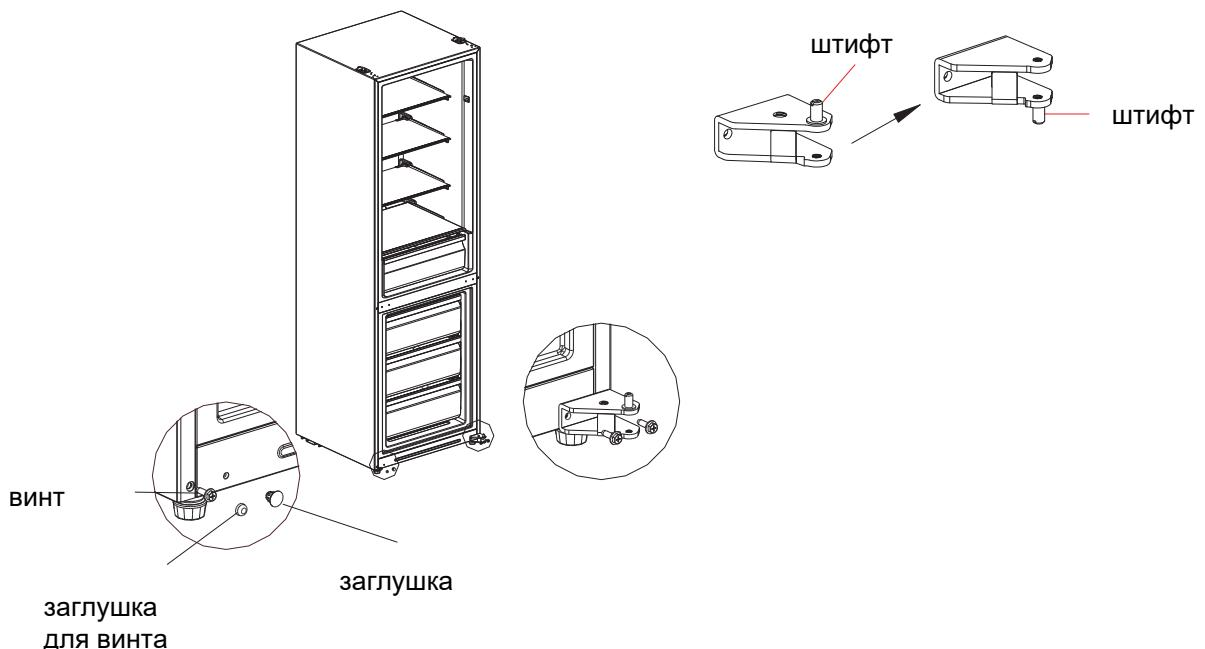
5. Снимите винты, втулку и заглушку на нижней торцевой крышке двух дверных корпусов и установите их последовательно с другой стороны дверных корпусов (заглушку необходимо заменить на новую из дополнительного пакета). Затем снимите верхнюю торцевую крышку дверцы холодильника и переключите жгут проводов с помощью втулки на другую сторону корпуса двери. Наконец, установите патрубок верхней петли на дверце холодильника в отверстие с другой стороны верхней торцевой крышки дверцы холодильника.
