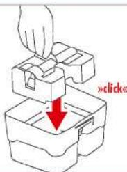
Установить вставку для защиты от расплескивания в резервуар для грязной воды, не извлекая всасывающий фильтр.
