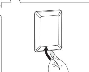
**1** С помощью отвертки снимите крышку.
