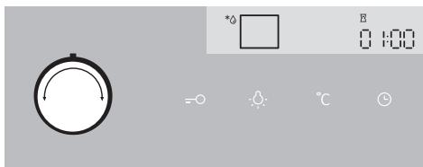
Установите переключатель РЕЖИМА НАГРЕВА в положение «Размораживание».
