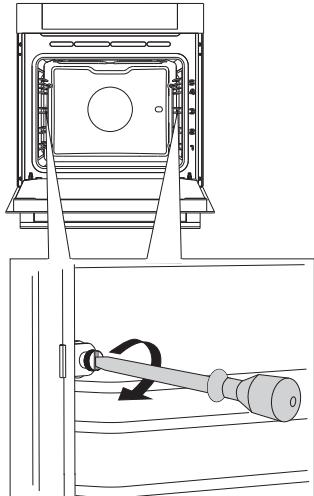
**1** Открутите винт с помощью отвертки.
