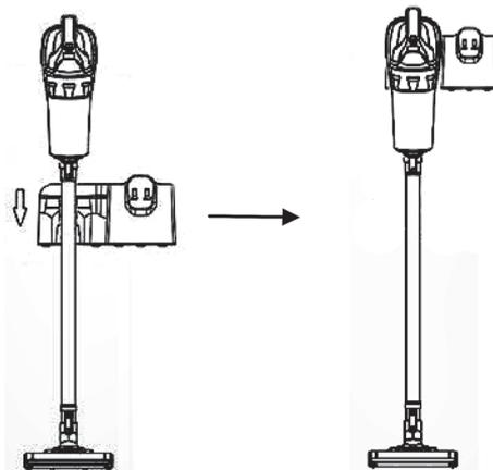
Есть возможность заряжать аккумулятор отдельно. Это удобно, если у вас несколько батарей. Нажмите на кнопку фиксатора и извлеките аккумулятор из пылесоса.
