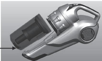
Извлеките из пылесборника циклонный фильтр. Для этого захватите пальцами выступ на крышке фильтра и вытащите его из пылесборника.
