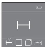
Після увімкнення вимірювальний інструмент знаходиться в режимі вимірювання довжини. Інші режими вимірювання можна настроїти кількаразовим натискуванням кнопки **3** або навігаційних кнопок **7** [+] чи **2** [-] (див. «Вимірювальні функції», стор. 75).
