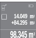
Wcisnąć przycisk pomiarowy **4**, aby rozpocząć kolejny pomiar powierzchni. Wyznaczyć powierzchnię zgodnie ze wskazówkami zawartymi w rozdziale »Pomiar powierzchni«, zob. str. 12. Aby zakończyć dodawanie, należy wcisnąć przycisk **4**. Aby dodać kolejne wartości pomiarowe, należy ponownie wcisnąć przycisk **7 [+]** itp.
