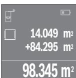
Apăsați tasta de măsurare **4**, pentru a începe o nouă măsurătoare de suprafață. Determinați suprafață conform paragrafului „Măsurarea suprafețelor“, vezi pagina 101. și pentru a finaliza adunarea, apăsați tasta de măsurare **4**. Petru adunarea altor valori măsurate, apăsați din nou tasta **7 [+]** s.a.m.d.
