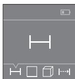
Қосудан соң өлшеу құралы үзындық өлшеу функциясында тұрады. Басқа өлшеу функцияларын **3** пернесін бірнеше рет басып немесе **7 [+]** немесе **2 [-]** пернелерін бірнеше рет басып реттеу мүмкін (“Өлшеу функциялары” 89 бетінде қараныз).
