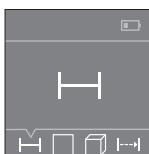
Nakon uključivanja mjerni alat se nalazi u funkciji mjerena dužina. Druge funkcije mjerena možete podešiti višekratnim pritiskom na tipku **3** ili na navigacijske tipke **7** [+] ili **2** [-] (vidjeti »Funkcije mjerena«, stranica 159).
