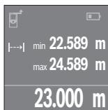
Za aktiviranje postupka mjerjenja pritisnite tipku za mjerjenje **4**. Mjerni alat pomičite sve dok se željena vrijednost udaljenosti ne prikaže dolje na displeju.
