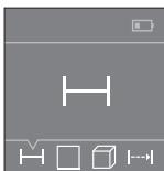
По вклучувањето, мерниот уред се наоѓа во функција на должинско мерење. Може да подесувате други мерни функции со повеќекратно притискање на копчето **3** или копчето за навигација **7 [+]** или **2 [-]** (види „Мерни функции“, страна 125).
