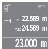
Притиснете на копчето за мерење **4** за активирање на мерниот процес. Двигнете го мерниот уред додека не се прикаже бараното растојание долу на екранот.
