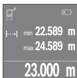
Pro spuštění postupu měření stiskněte tlačítko měření **4**. Měřicím přístrojem pohybujte tak dlouho, až se dole na displeji objeví požadovaná hodnota vzdálenosti.
