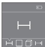
Po zapnutí se měřicí přístroj nachází ve funkci měření délky. Ostatní měřicí funkce můžete nastavit opakováním stisknutí tlačítka **3** nebo navigačních tlačítek **7 [+]** nebo **2 [-]** (viz „Měřicí funkce“, strana 24).
