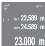
Lai uzsāktu mērijumu, išlaicīgi nospiediet mērišanas taustiņu **4**. Pārvietojiet mērinstrumentu, līdz displeja apakšējā vērtību rindā parādās vēlamā attāluma vērtība.
