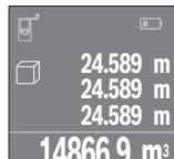
Nakon dovršetka trećeg mjerenja, volumen se automatski izračunava i prikazuje. Konačni rezultat prikazan je na displeju dolje, a pojedinačne izmjerene vrijednosti iznad njega.
