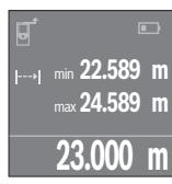
A mérési eljárás kiváltásához nyomja meg a **4** mérőgombot. Mozgassa addig a mérőműszert, amíg a kijelzőn a kívánt távolság értéke meg nem jelenik.
