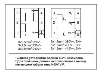
При использовании индукционной конфорки необходим кабель следующего типа: H05VV-F 3X2,5 мм2/60227 I EC 53 . Схема соединений расположена на дне устройства..
