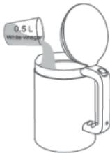
1. Налейте в чайник 0.5 литра столового уксуса в чайник, и не включая чайник, оставьте на один час.
