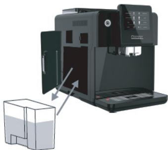
Откройте левую боковую дверцу и извлеките резервуар с водой. Перелейте в него раствор со средством от накипи, а затем долейте чистой воды до максимальной отметки.
