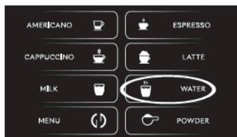
Нажмите кнопку подачи горячей воды WATER, чтобы кофемашина начала подачу горячей воды.
