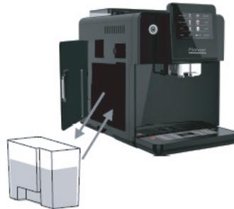
Откройте левую дверцу и извлеките из кофемашины резервуар для воды. Наполните резервуар чистой прохладной водой и установите обратно. Убедитесь, что резервуар установлен на свое посадочное место, и закройте левую дверцу.
