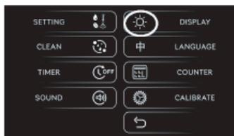
Нажимайте кнопку настройки яркости подсветки сенсорного дисплея DISPLAY, чтобы установить подходящий уровень яркости. Всего имеется три режима: энергосберегающий (низкая яркость), средний и обычная яркость.
