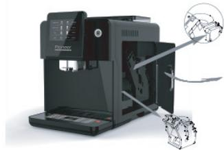
Нажмите на рычаг и извлеките варочный блок из кофемашины. Промойте варочный блок чистой водой под краном, затем дайте ему высохнуть. Очистите внутреннюю камеру от остатков молотого кофе кофемашины мягкой щеткой.
