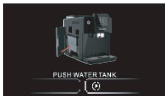
Отсутствует герметичность, резервуар для воды неправильно установлен.
