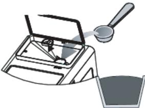
Насыпьте одну или две мерных ложки молотого кофе без горки в отверстие для молотого кофе.
