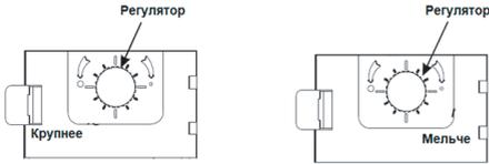
Откройте левую дверцу и отрегулируйте вспенивание молока соответствующим регулятором.
