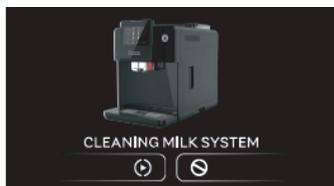
Если на дисплее отображается индикация «CLEANING MILK SYSTEM», это означает, что необходимо провести автоматическую промывку капучинатора и трубки для молока.
