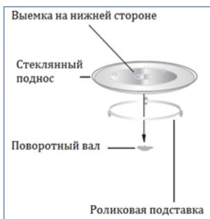
На поворотный вал устанавливается стеклянный поднос. Под стеклянный поднос устанавливается роликовая подставка, которая помогает подносу свободно вращаться. Вращение пищи во время работы печи способствует ее равномерному приготовлению.
