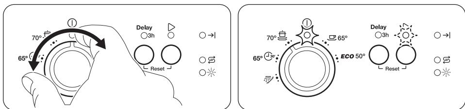
Бағдарламаны бастау үшін құрылғы Бағдарламаны таңдау режимінде тұруға тиіс. Егер басқару панелінде бұндай жағдай көрсетілмесе Reset функциясын қосыңыз.
