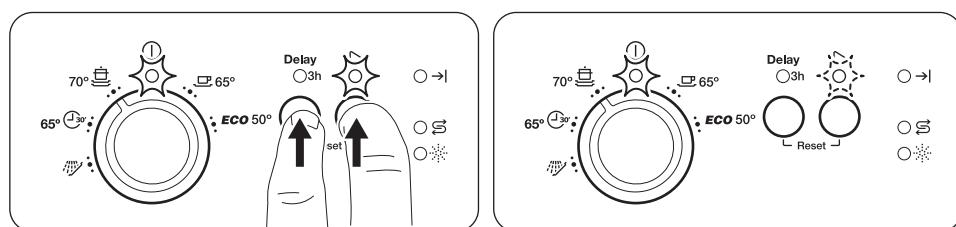
Кнопка **Reset** дає змогу скасувати діючу програму або відкладений запуск. Прилад повертається в режим вибору програми.
