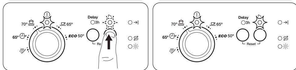
Відкрийте водопровідний кран, закройте дверцята, виберіть програму та натисніть **▷**.
