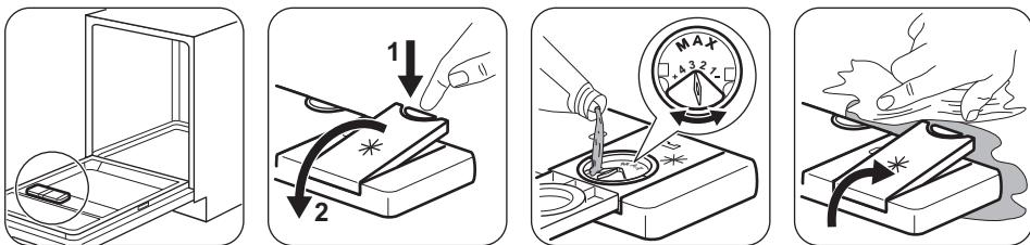
Завдяки ополіскувачу на посуді після висихання не залишаються смуги та плями. Це автоматично спрацьовує під час фази гарячого ополіскування.
