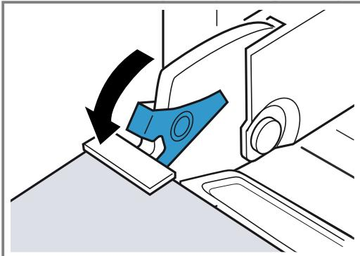
3. Прикройте дверцу прибора так, чтобы она оставалась открытой примерно на 30°.
