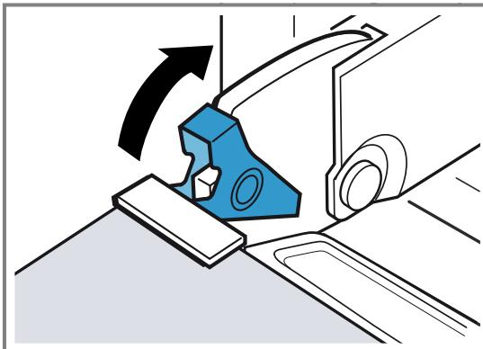
Когда блокировочные рычаги открыты, петли дверцы зафиксированы и не могут захлопнуться.
