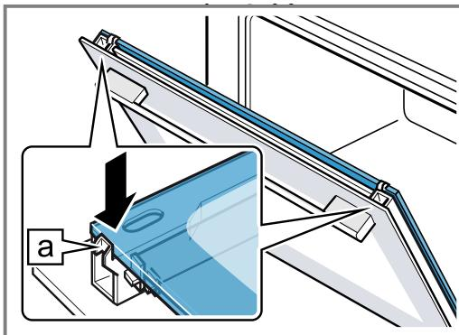
5. Установите защитную панель и прижмите её так, чтобы она зафиксировалась со слышимым щелчком **①**.
