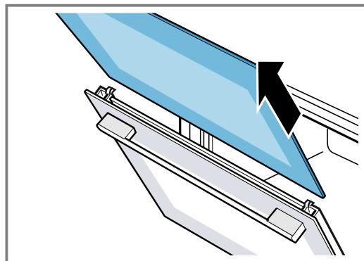
5. Если необходимо снять и очистить планку для конденсата, полностью откройте дверцу прибора.
