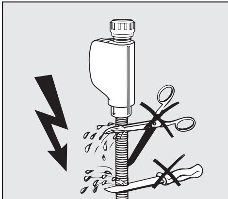
**⚠️** Не допускается укорачивание или повреждение шланга подачи воды, так как в нем имеются детали, находящиеся под напряжением (см. рисунок).
